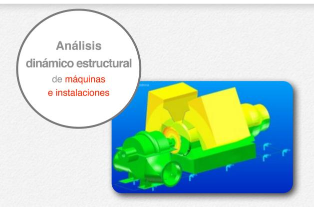
En sus modos operacional (máquina en marcha), experimental y analítico persigue la caracterización del comportamiento dinámico en lo referente a los modos de vibración, frecuencias propias y parámetros estructurales (amortiguación, rigidez y masa).
