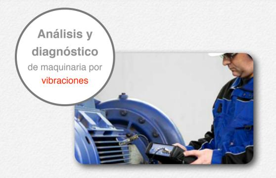
El análisis de vibraciones en máquinas rotativas es la técnica fundamental para el diagnóstico de la mayor parte de los problemas electromecánicos en la maquinaria crítica.
