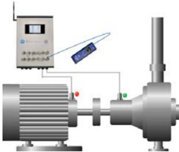
Fig. 3. Sistema online con salidas BNC montado a pie de máquina.
