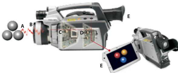
La termografía de infrarrojos es el arte de transformar una imagen de infrarrojos en una imagen radiométrica que permita leer los valores de temperatura. Por tanto, cada píxel de la imagen radiométrica es, de hecho, una medición de temperatura. Para ello, se incorporan complejos algoritmos a la cámara de infrarrojos. Esto hace de la cámara termográfica una herramienta perfecta para el mantenimiento predictivo.
