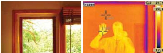
La ventana refleja radiación térmica, de forma que, para la cámara termográfica, la ventana actúa como un espejo.
