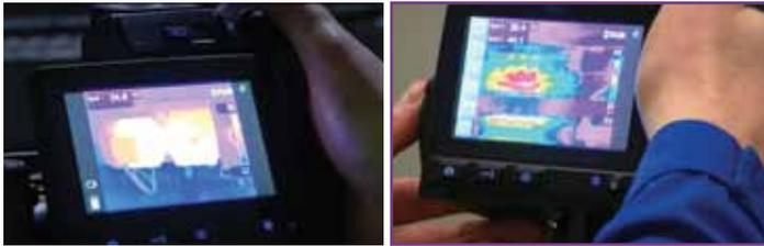
Cuando disponga de una base de datos de imágenes de referencia, puede determinar qué temperaturas son aceptables para cada pieza del equipamiento y definir un umbral de alarma de temperatura. Esto permite a la cámara activar una alarma si alguna parte de la termografía se calienta demasiado, lo que ayuda a agilizar las inspecciones futuras. Registre esta alarma de temperatura para usarla más adelante.
