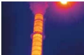
*Inspección de material refractario en la chimenea de un horno.*
