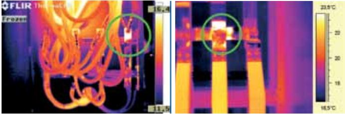
*Estos dos "puntos calientes" pueden parecer zonas cálidas pero, en realidad, esto está causado por la reflexión de las superficies metálicas no oxidadas. Un indicador es el hecho de que los verdaderos puntos calientes suelen mostrar un patrón homogéneo, a diferencia de las reflexiones.*
