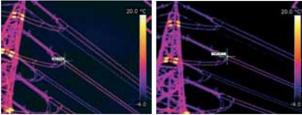
*Una mejor resolución de la imagen también conlleva una mayor precisión de la medición. La termografía de 640 x 480 píxeles de la izquierda muestra una temperatura de 63,9 °C, mientras que la termografía de 320 x 240 píxeles de la derecha indica 42,7 °C*
