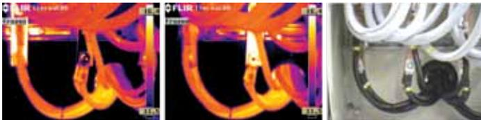
*El hecho de que el "punto caliente" de la imagen intermedia desaparezca cuando se cambia ligeramente la ubicación de la cámara termográfica demuestra que este aparente "punto caliente" está causado por la reflexión. Este es otro indicador.*
