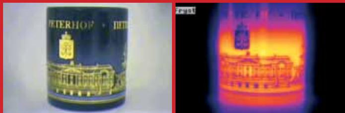
*Si observa la termografía, es posible que piense que la pintura dorada es más fría que la superficie de la taza. En realidad, tienen exactamente la misma temperatura, la diferencia en la intensidad de la radiación infrarroja está provocada por una diferencia en la emisividad.*
