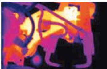
*Punto caliente en robot de soldadura*
