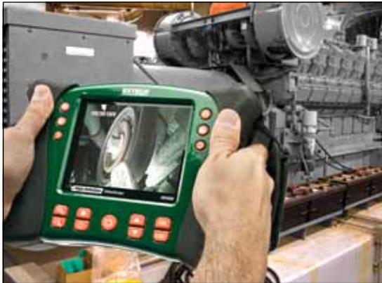
Las cámaras de diámetro estrecho con monitor LCD en color de alta definición de 14,5 cm ofrecen alta resolución de vídeo e imágenes en una gran pantalla en color
