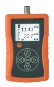
Este vibrómetro dispone de un sensor acelerómetro externo que se acopla a la máquina mediante una base magnética incorporada y nos facilita los valores de la vibración y la temperatura del punto de medición. De este equipo destaca su capacidad para guardar hasta 100 lecturas y su función estetoscopio. El vibrómetro PRE5014 mide valores de vibración rms, pico, pico a pico, factor de cresta y estado de rodamientos. Las lecturas se pueden visualizar fácilmente mediante su pantalla LCD en color.
