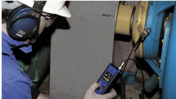
Vibrómetro para TPM modelo PRE5050
