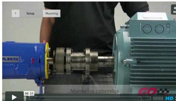
La alineación de ejes acoplados mediante equipos de alineación láser aporta grandes ventajas sobre la tradicional alineación mediante relojes comparadores:
