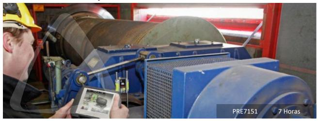
Objetivos: El curso forma al asistente para poder realizar alineaciones de ejes acoplados mediante técnicas que garantizan la precisión de la alineación.
