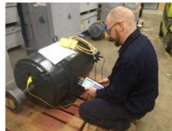
*Erik Lehman, Técnico de Servicio de Koontz-Wagner, utiliza el ALL-TEST PRO 5™ para realizar la inspección inicial de un motor de 50Hp en el taller de reparaciones.*
