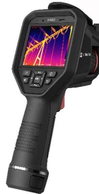
La cámara portátil HIKMICRO M60 está especialmente diseñada para la medición de temperatura. Equipada con un detector térmico de resolución  $640 \times 480$ , ayuda a encontrar rápidamente los objetivos de alta temperatura en el entorno de trabajo. Asimismo, ayuda en la toma de decisiones y garantiza la seguridad. Este dispositivo se aplica principalmente en sectores como la construcción, HVAC, industria automotriz, etc.
