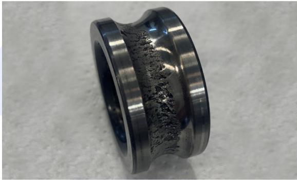
¿Por qué no coinciden las trazas de fallo teóricas con las registradas en las firmas espectrales? Como se puede observar en la imagen del rodamiento, el deterioro de la pista interna no está centrado en el camino normal de rodadura, sino que se desplaza hacia un lateral, generando un ángulo de contacto (40° aprox). Este ángulo de contacto afecta al cálculo de las trazas de fallo del mismo, que como se dijo anteriormente dependen únicamente de su geometría.
