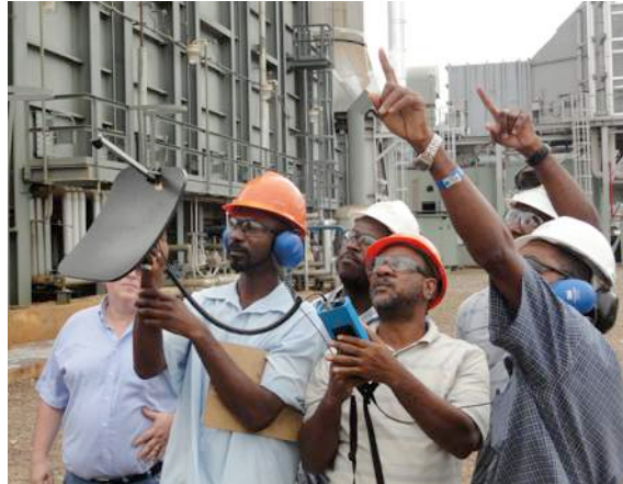
Fig. 9. Equipo de detección de ultrasonidos SDT270 con sensor parabólico.
