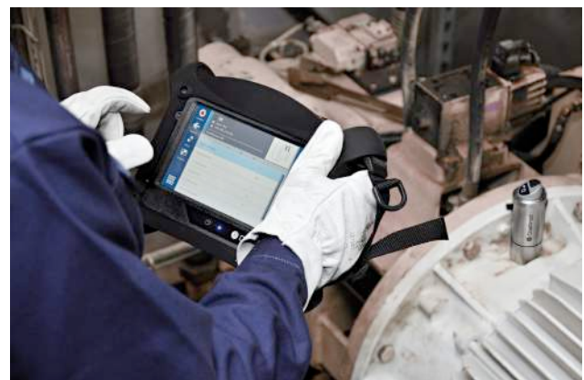
Fig. 1. Colector analizador portátil para toma de datos de vibración en rutas de inspección predictiva.
