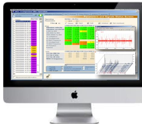
Fig. 2. Software para diagnóstico predictivo de maquinaria por análisis de vibraciones.
