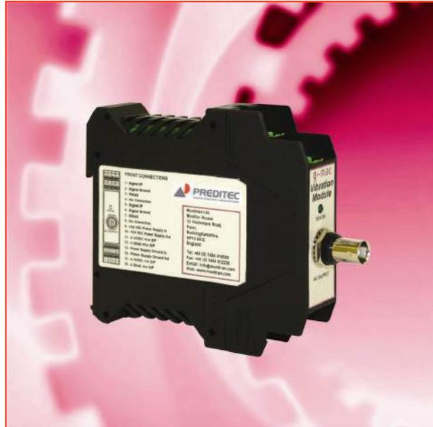
El módulo transmisor de vibración para acelerómetro **PRE 1290** envía al sistema de control distribuido dos indicadores para hacer seguimiento y alertar de posibles fallos en rodamientos y engranajes, así como vibración estructural de baja frecuencia ocasionada por desequilibrios, desalineaciones, holguras, etc.. Este módulo sustituye y mejora de una manera mucho más económica a la tradicional instrumentación de vibraciones para protección de maquinaria.
