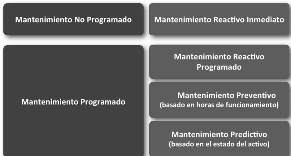
Fig. 3. Las intervenciones de mantenimiento pueden programarse o no, el origen de cada intervención de mantenimiento programado puede deberse a una acción reactiva, preventiva o predictiva.
