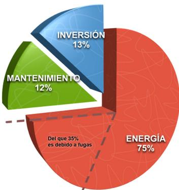
Los costos generados en una instalación de aire comprimido se distribuyen de la forma que se muestra en el gráfico adjunto:
